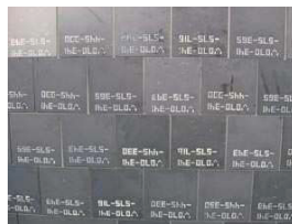
Fig.2 Piastrelle di isolamento sul lato inferiore delle ali del modello Explorer di Shuttle
