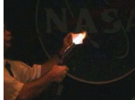
Fig.3 Verifica della dispersione del calore mediante le piastrelle di isolamento al Kennedy Space Center
